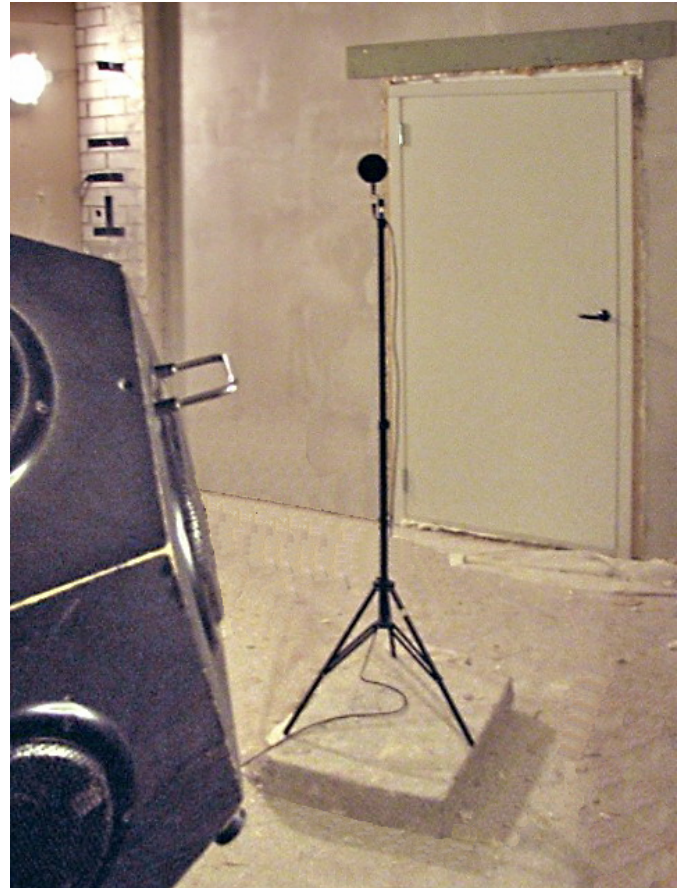
4.zīm. Situācija sekundārajā telpā, mērot reverberācijas laiku ar paraugu Nr. 761-1 .
