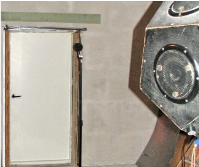
3.zīm. Durvju bloka (paraugs Nr.761-1) mērījuma situācija primārajā telpā.
