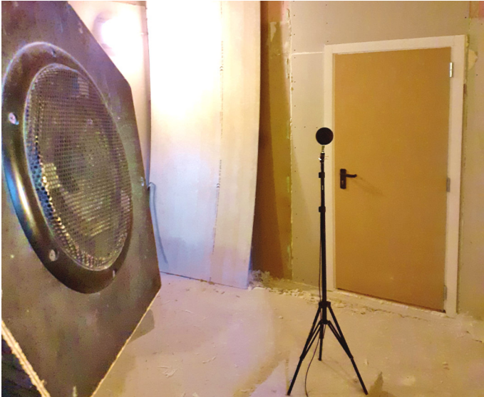
3.zīm. Situācija sekundārajā telpā, mērot reverberācijas laiku ar paraugu Nr.904-3.
