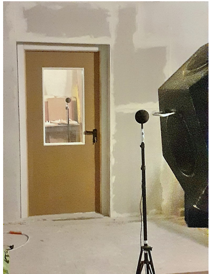
4.zīm. Durvju bloka (paraugs Nr. 904-2 ) mērījuma situācija primārajā telpā.
